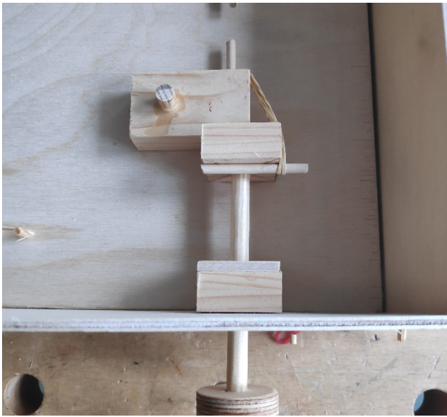
Hoobade kontrollimise mehhanism
