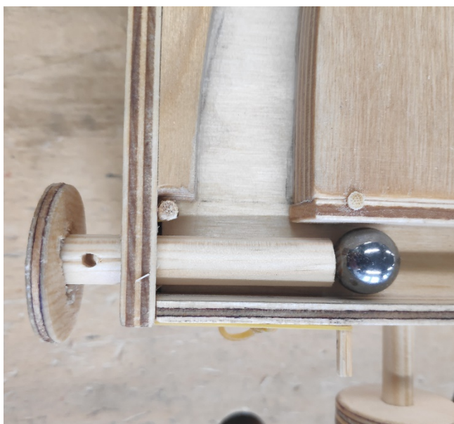
Kuuli väljakule päästmise mehhanism
